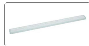
escala para calibração de 300mm (em conjunto com a escala de 50mm pode-se verificar a incerteza de ampliação e de medição)
